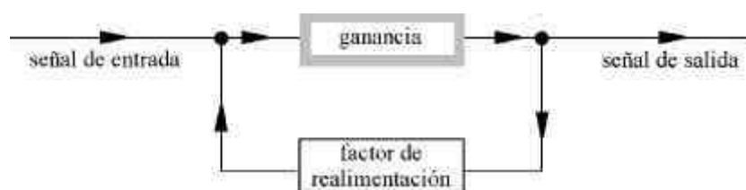
Fig. 5.2 Esquema del funcionamiento de un mecanismo de realimentación
